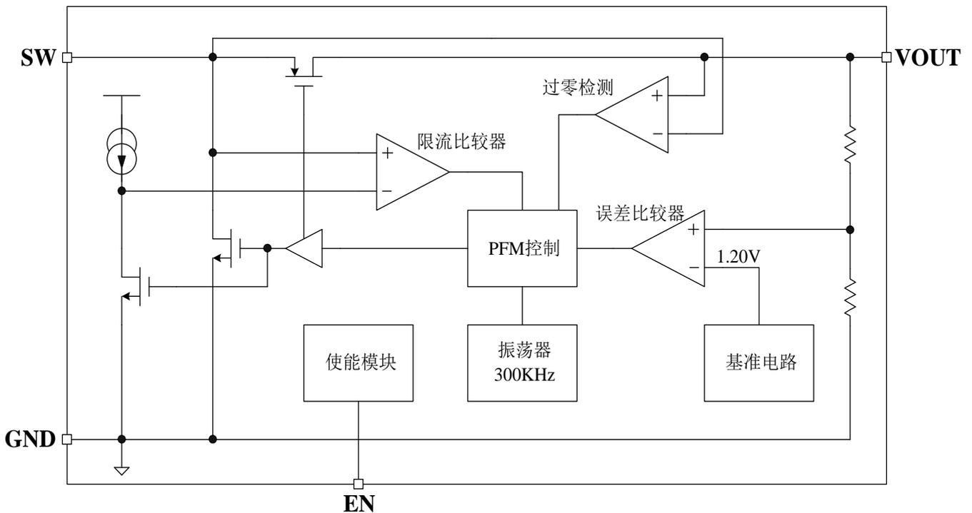
图 2: QX2304 的内部电路方框图
