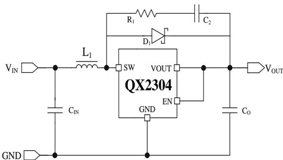
图 3：QX2304 大电流应用电路图
